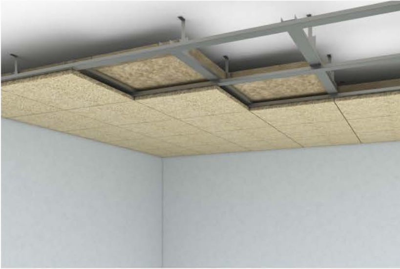
Общий вид подвешного потолка. Плита 600*600мм. Скрытая подсистема
